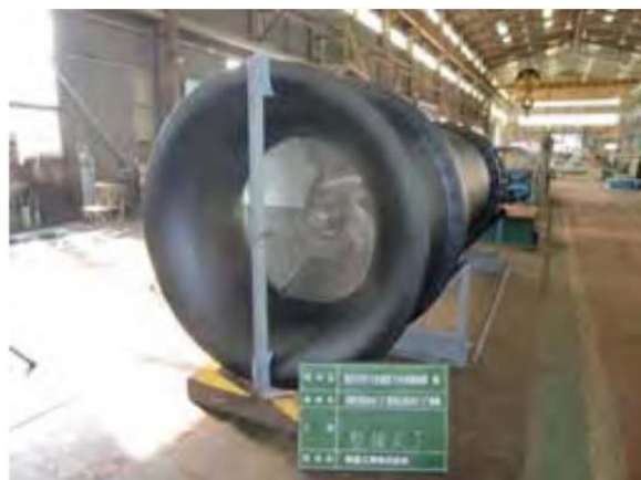
【ポンプの組立後】
