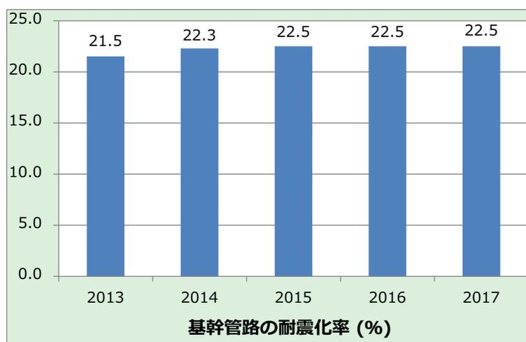
計算式：(基幹管路のうち耐震管延長/基幹管路延長) × 100
